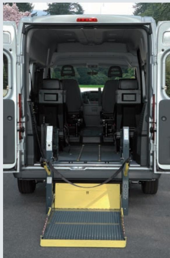
**I**ngresso posteriore tramite sollevatore a doppia colonna Ricon, capacità di carico 350 kg.
