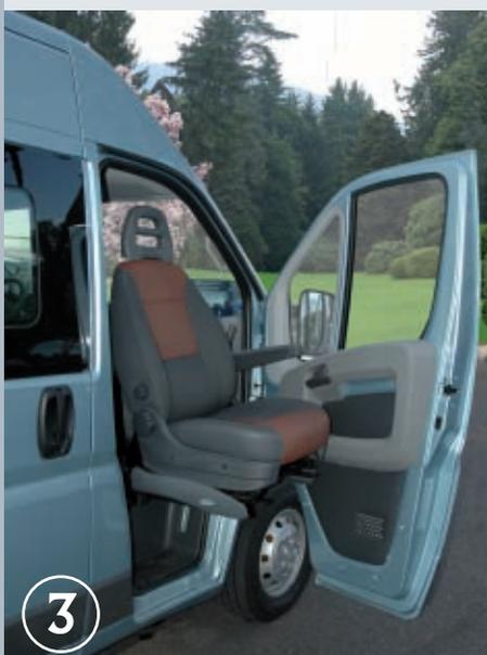
Utilizzando il sistema D-Tran è possibile accedere sia al posto passeggero che a quello di guida.
